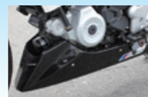
▲転倒などによるエンジン破損に備え、アンダーカウルの装着は必須。エンジンカバーの装着も有効
