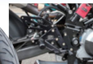
▲ポジション変更に必要なバックステップ。バンク角の確保にも有効
