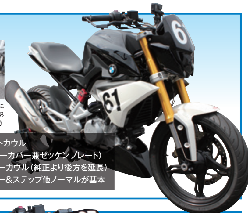
▲転倒などによるエンジン破損に備え、アンダーカウルの装着は必須。エンジンカバーの装着も有効
